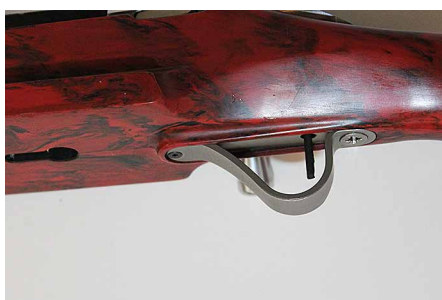
Liipaisinkaari sekä liipaisin ovat erikoisen näköiset. Hylsynpoistoaukko näkyy liipaisinkaaren etupuolella.
