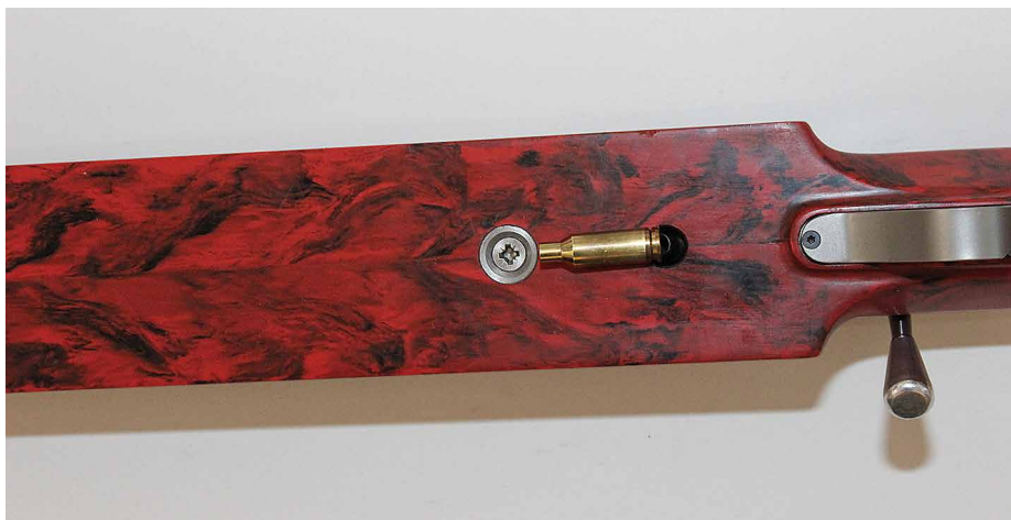
Hylsynpoisto tapahtuu poikkeuksellisesti tukin pohjan kautta suoraan alaspäin.
