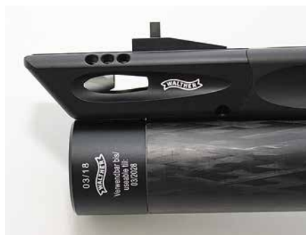
Koeampuja arvioi kompensaattorin toimivaksi. Etutähtäimen etäisyys on säädettävissä. Hiilikuidulla vahvistetun alumiinisäiliön käyttöikä on selkokieli-sesti ilmoitettu.
