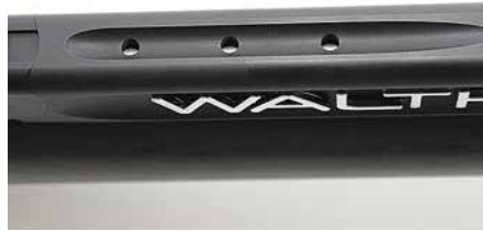
Piippuvaippa on rei'itetty piipun hyp-päystä ehkäisemään, tosin vastaavasti rei'itetty piippu on valinnaisvaruste.
