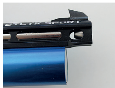
Steyrin kompensattori purkaa ilmaa sivuille. Jyvä on kiinteä mutta kallistettavissa sivusuunnassa.
