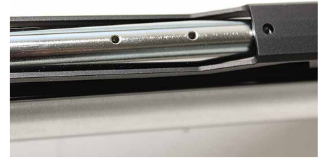
Piippu on rei'itetty painepiikin minimoimiseksi.
