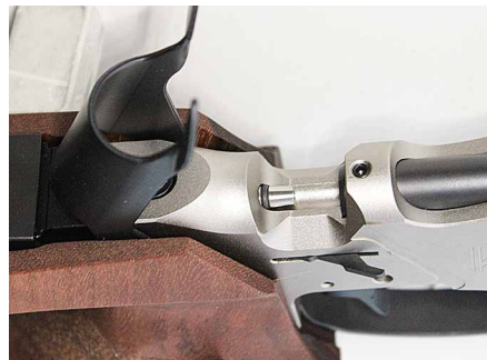
Luotikouru on hieno asia. Asetetaan vain luoti kouruun (oikein päin!) ja suljetaan latausportti.
