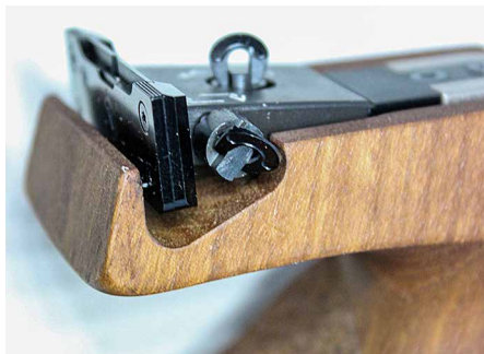
Tähtäimen säädössä käytetään erikoisia läpysköitä joka taivuttavat litteäksi kun eivät käytössä.
