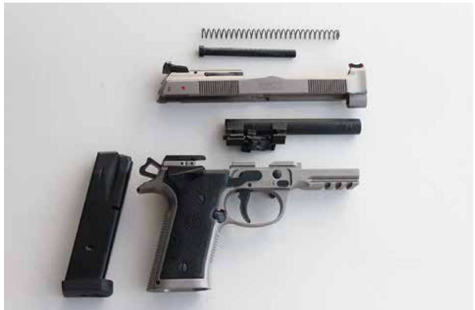
92X huoltopurettuna. "Älä pura enempää", sanoo herra Beretta.
