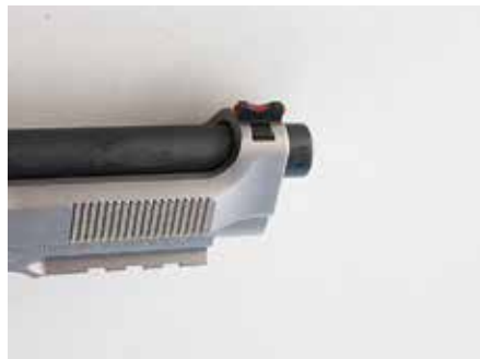
Etutähtäin on loistejyvä. Virityskarhennukset ja viisteet löytyvät myös luistin keulalta.
