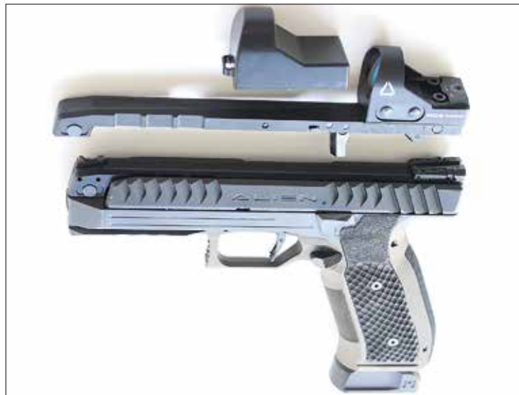
Vaihdeettavat tähtäinkiskot mahdollistavat nopean vaihdon lajista toiseen. Ylemmässä punapistekiskossa näkyy iskuvasara lauenneena.
