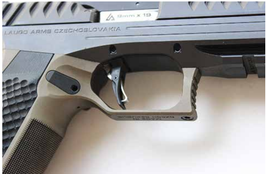
Laugossa on liipaisinvarmistin. Kirkasta läpyskää on puristettava ennen kuin ase laukeaa. Liipaisinkaaren etuosa on karhennettu kahden käden otetta varten.
