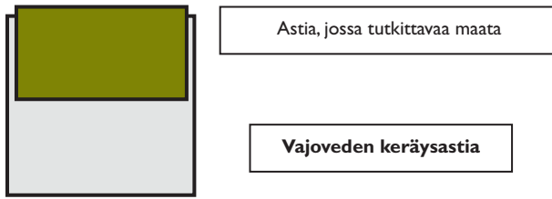
Kuva G1. Yksinkertaisen lysimettrin periaate.
