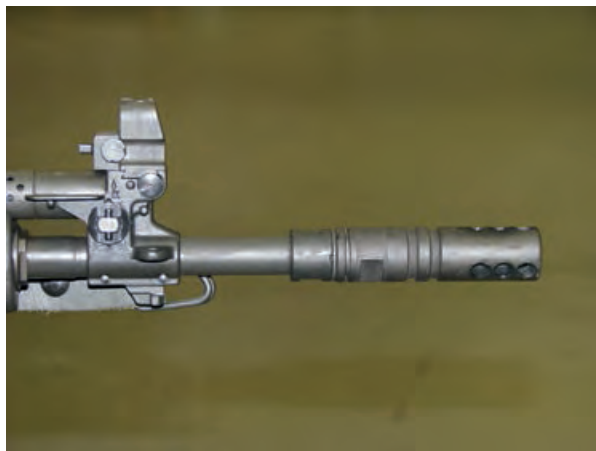
Kuva 9.2. Vasemmalla integroitu (kuva Löppö Production) ja oikealla erillisenä osana valmistettu ja asennettu suujarru (SA kuva).
