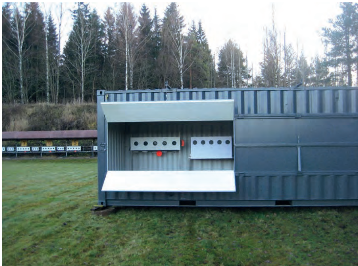
Kuva 5.11. Merikonttiin asennetut ampumahiidhon maalilaitteet ja luotiloukut, prototyyppi (kuva Pauli Harjula).
