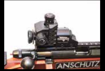
Anschützin 7020 takatähtäin on tarkkuusinstrumentti, joka maksaa yksistään noin 600 euroa. Kuvassa lukko on vireessä, jolloin vireindikaattori näkyy lukon perästä.
