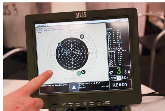
SIUSin elektronisen taulujärjestelmän ohjaus on helppoa näyttölaitteesta. Se on myös sormiohjattava.
