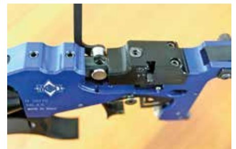
MG H1 ladataan pystysuoraan. Luoti asetetaan aukkoon, joka näkyy sinisen ja mustan osan välissä. Latausvivun sulkeminen kääntää luotia 90°.
