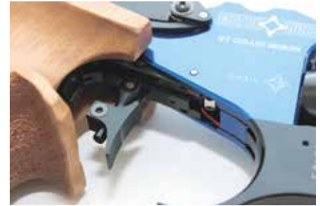
Monet laukaisulaitteen säädöistä ovat käsillä kahvaa irrottamatta. Liipaisimen asento on monipuolisesti säädettävissä.
