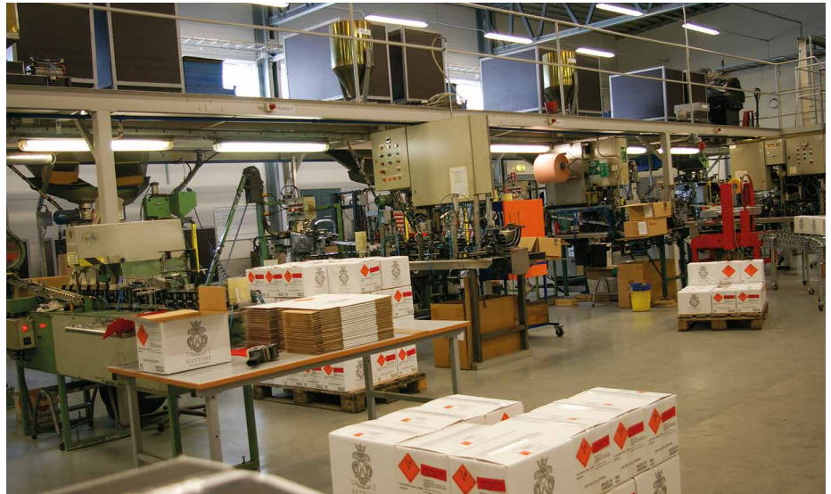
Automaattikoneet pakkaavat patruunat rasioihin ja rasiat lähetykskartonkeihin.
