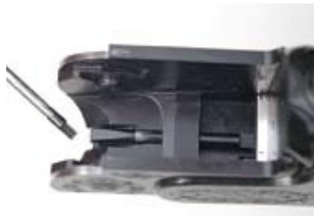
Iskurit virittävät yhden työntötangon kautta. Saranatatit ovat vaihdettavat.
