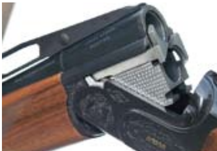
Sulkupintojen pyöröhiointa on laadukas yksityiskohta. Ejektorien kynnet ovat jämerän näköiset.
