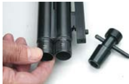
Suuhiset ovat sormin kiinnitettävät. Avaimen pykälät puuttuvat kokonaan. Suuhisavain on kartiotyyppinen.
