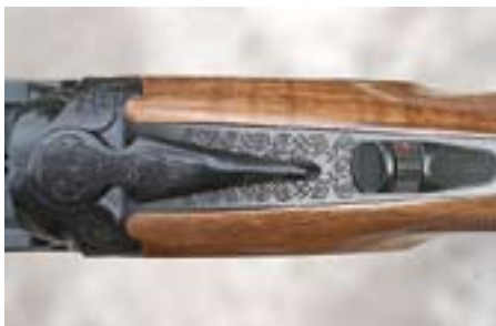
Varmistin ei mene automaattisesti "S"-asentoon. Piipunvalitsin liikkuu poikittain varmistimen nupissa.
