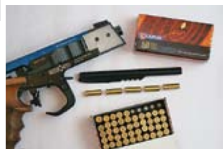
Viiden patruunan putkilipas on Cesare Morinin tavaramerkki. Pistooleissa harvinainen, mutta kivääreissä 150 vuotta käytetty.
