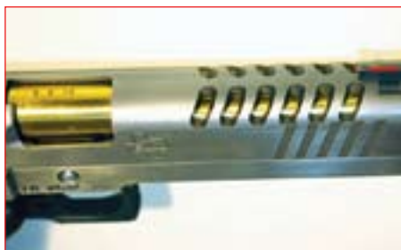
Luistin leikkaukset toimivat virityskarhennuksina ja piipun jäähdytysaukkoina.
