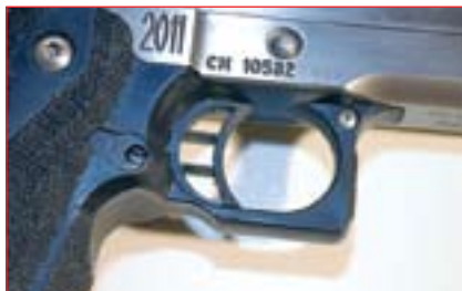
Liipaisin on superkevyt komposiittirakenteinen. "Stiplus-tyyppiset" karhennukset on työstetty suoraan runkoon. Erillisiä kahvaleyviä ei ole.
