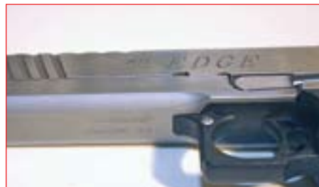
"Georgetown, Texas" on STI:n kotipaikka. Rungon alaosaan puuttuvat alkuperäiselle 1911:lle tunnusomaiset viisteet.
