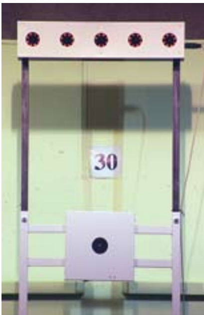
Taulu ja IR-lähtetin ovat alhaalla. Ylhäällä näyttölaitte ”putoavat taulut” eli laukaus on joko osuma tai ohi.
