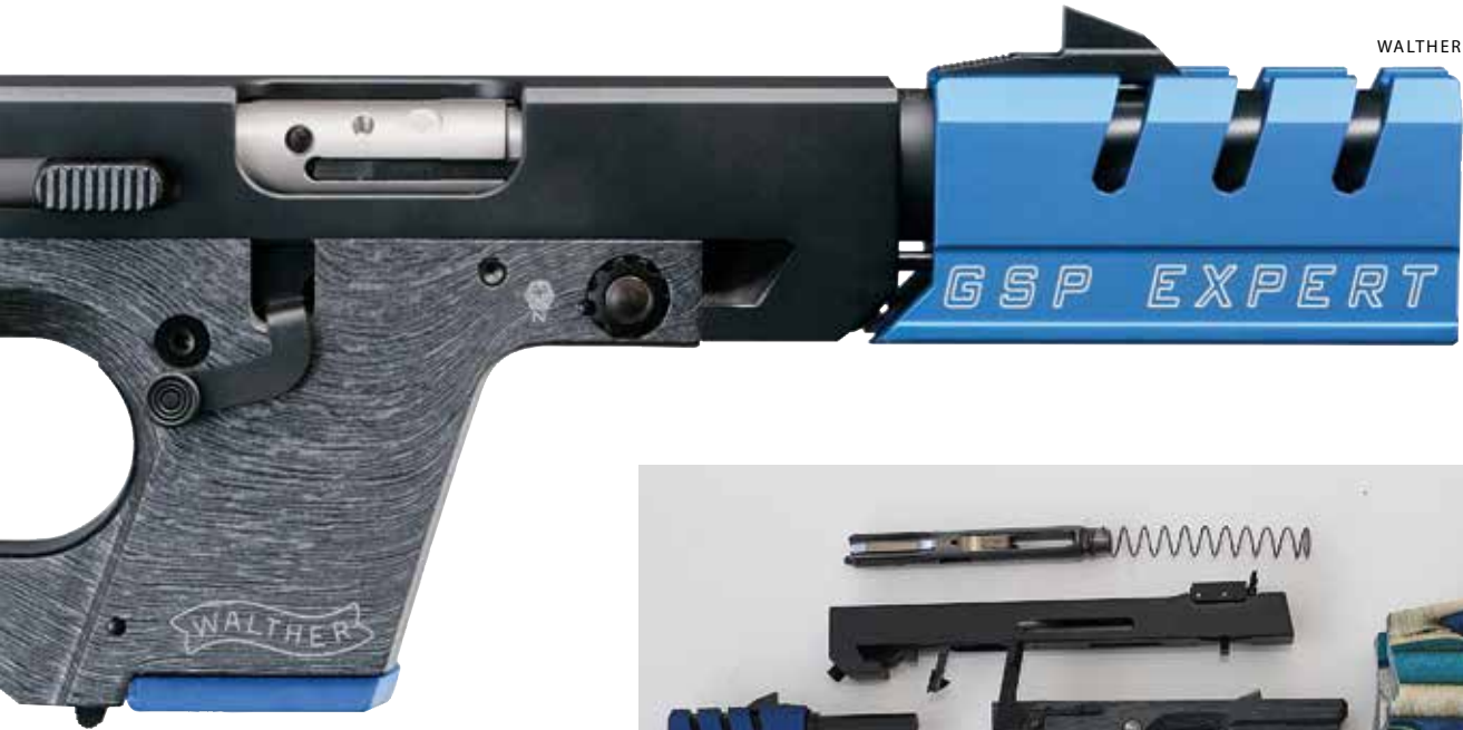
Liipaisimen edessä näkyy lukkosalpa. Liipaisinkaaren alapuolella näkyy pienikokoinen lipassalpa. Kuvassa lukko on lukittu taka-asentoon.
