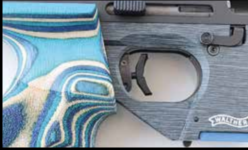
Liipaisimen edessä näkyy lukkosalpa. Liipaisinkaaren alapuolella näkyy pienikokoinen lipassalpa. Kuvassa lukko on lukittu taka-asentoon.
