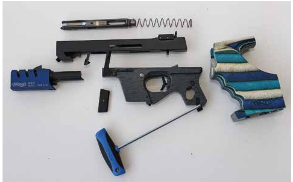
GSP huoltopurettuna, mutta laukaisulaite on vielä kiinni alakerrassa. T-avaimen kärki osoittaa nippeliä, johon kahvan kiinnitysruuvi pitää saada osumaan.
