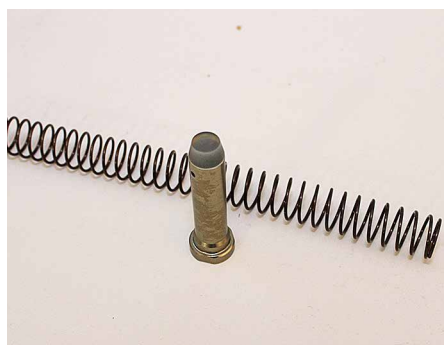
UR:n rekyylijousi on pitkä ja suurihalkaisijainen. Buffer eli rekyylinvaimennin kesyyttää rekyyliä ja palauttaa tähtäinkuvan nopeammin.
