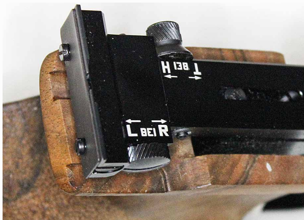
Takatahtäimen säädöt ovat monipuoliset. Sivu ja koro säätävät sormipyörillä. Hahlon säätöön tarvitaan uraruvimeisseliä.
