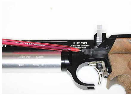
Kynä osoittaa viritysviistettä (ovat molemmin puolin). Liikematka on lyhyt ja tarvittava näppivoima melkoinen.
