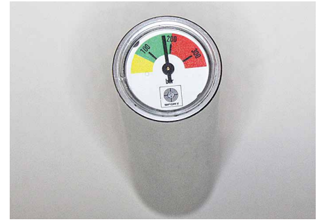
Säiliön painemittarin asteikko on kellomallia ja värisektoreilla varustettu.
