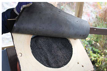
Tästä kumilevystä on ammuttu läpi jo monta kertaa. Kumirouhe näyttää olevan ihanteellinen luodin "jarru".
